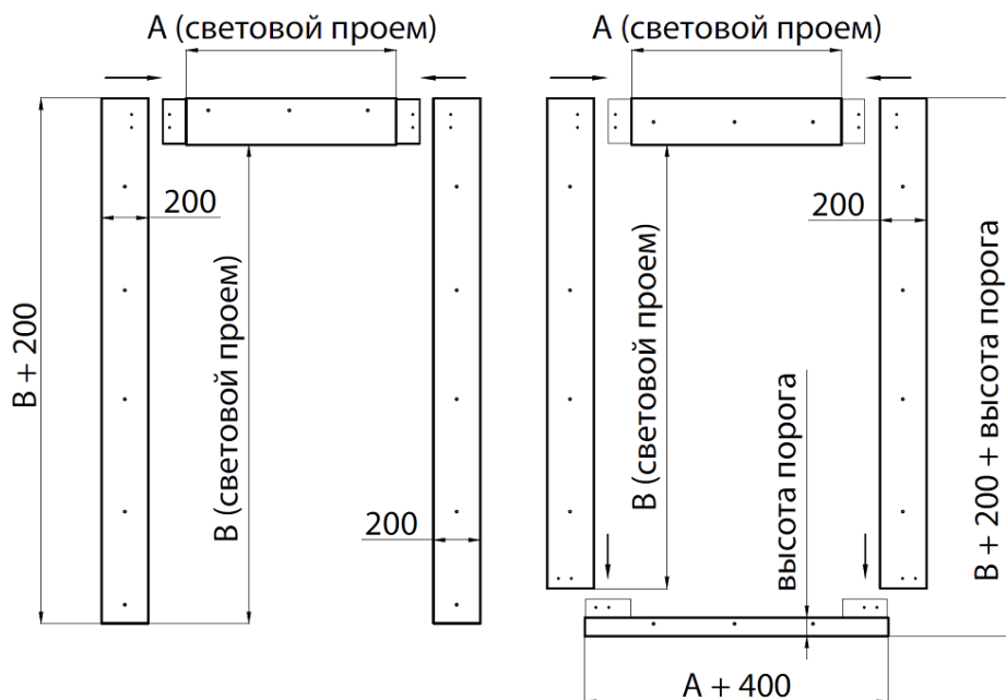
Рисунок 2. Металлическая накладная рама для дверей ОД П Слева – без порога, справа – с порогом
